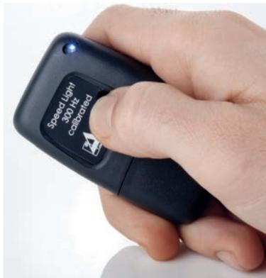
Bitte regulieren Sie die Geschwindigkeit so lange, bis der Eindruck entsteht dass die Striche stehen. Dann haben Sie die exakte Geschwindigkeit erreicht.
